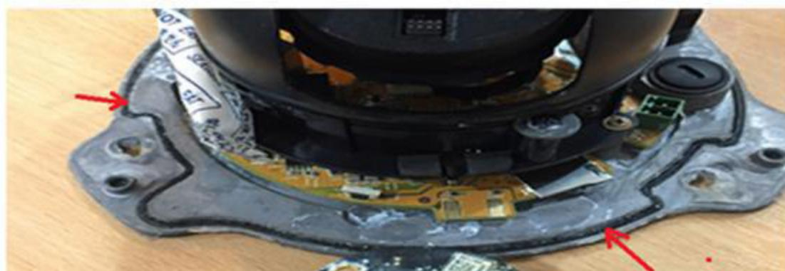
• همانطور که در شکل بالا دیده می شود، دور کفی یک حلقه اورینگ وجود دارد. این حلقه نباید دچار پاره شدگی و آسیب دیدگی شود.
